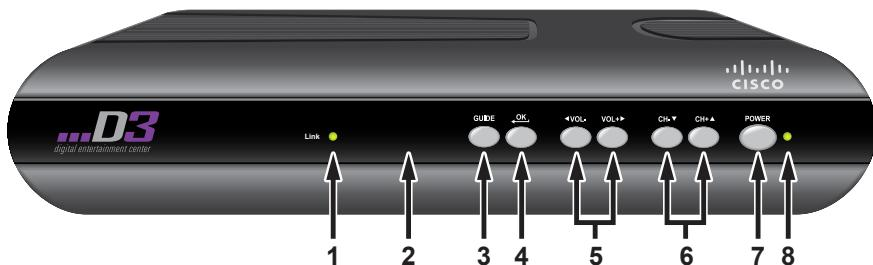
1. LINK Svetli zeleno kada je uspostavljena veza sa eksternim modegom koji služi za dvosmernu komunikaciju između digitalnog prijemnika i operatora.
